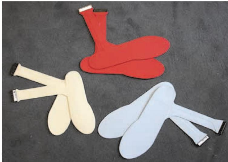
**Figura 1.1-13.** Plantillas de sensores de presión. Son flexibles para poder colocarlas dentro de los zapatos.
